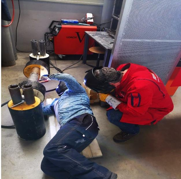
**Modul 3-5:** Kenntnisse im relevanten WIG-Schweißprozesse erlangen und die Fähigkeit einseitig geschweißte Stumpfnähte an Rohren in den Positionen PA, PF, PC herzustellen
